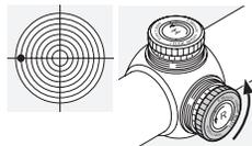
Tournez la vis moletée du réglage latéral dans le sens de la flèche R - dans le sens inverse des aiguilles d'une montre.
