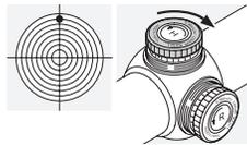
Поверните ролик коррекции по вертикали в направлении, противоположном Н - по часовой стрелке.
