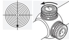
Draai de kartelknop van de hoogteverstelling in de pijlrichting H - tegen de wijzers van de klok in.
