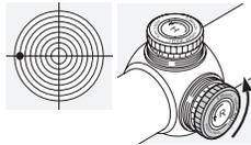
Ruotare il bottone zigrinato della regolazione laterale in direzione della freccia R, in senso antiorario.
