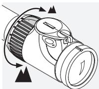
Girando l'anello di regolazione dell'ingrandimento di 180° potete regolare l'ingrandimento a piacimento. La scala sull'anello di regolazione consente una facile e comoda lettura della regolazione. Per consentire un migliore orientamento, il morbido rivestimento scanalato dell'anello di regolazione è provvisto di una sporgenza.
