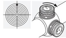
Drehen Sie den Rändelknopf der Höhenverstellung entgegen der Pfeilrichtung H - im Uhrzeigersinn.
