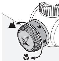
Con la torre de paralaje podrá ajustar la nitidez óptima para cualquier distancia al objetivo y evitar el error de puntería por paralaje.
