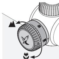
Con la torretta parallasse è possibile regolare la nitidezza ottimale per qualsiasi distanza di puntamento evitando così errori di mira dovuti a parallasse.
