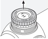
1. Entkoppeln Sie zuerst den Rändelknopf durch Zug nach oben. In dieser Stellung wird beim Verdrehen des Rändelknopfes das Absehen nicht verstellt.
