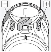
In dem von Ihnen gewählten Modus können Sie nun die Helligkeit mittels der +/- Taste einstellen. Zum schnellen Finden der optimalen Helligkeit können Sie die Taste gedrückt halten (Dauerimpuls). Durch einmaliges Drücken der Tasten (Einzelimpuls) nehmen Sie die Feinjustierung vor.
