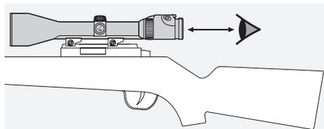
Prestare attenzione alla distanza interpupillare predefinita in caso di cannocchiale da puntamento montato sull'arma. (Per le misure, vedi la scheda dati.)
