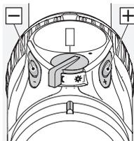
I modusen, som du har valgt, kan du indstille lysstyrken vha. knappen +/- . Du kan holde knappen nede (konstant impuls) for hurtigt at finde den optimale lysstyrke. Ved at trykke en enkelt gang på knappen
