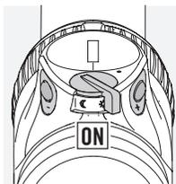
Функцию SWAROLIGHT можно выключить, нажав одновременно кнопки +/- на 5 секунд. Выключение подтверждается двукратным миганием светящейся точки. При повторении этого действия функция
