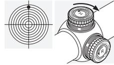
Vrid höjdjusteringsratten motsatt mot pilriktningen H - dvs. medurs.
