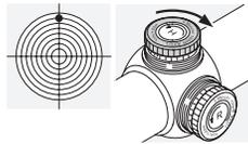
Ruotare il bottone zigrinato della regolazione dell'altezza in senso contrario rispetto alla direzione della freccia H, in senso orario.
