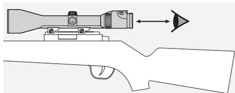
Vær opmærksom på den angivne øjenafstand for riffelokkerten, som er monteret på våbnet (mål, se databladet).
