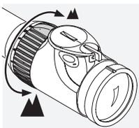
Путем поворота маховика на 180° фокусировки бесступенчато изменяется кратность увеличения. Благодаря наклонной шкале обеспечивается
