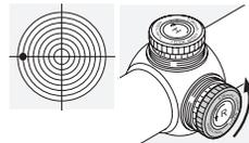
Vrid sidjusteringsratten i pilriktningen R - dvs. moturs.
