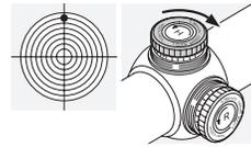
Draai de kartelknop van de hoogteverstelling tegen de pijlrichting H in - met de wijzers van de klok mee.
