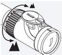
Girando el anillo de ajuste de aumentos, hasta 180° puede obtener de forma gradual el aumento deseado. La escala del anillo de ajuste permite ver clara y fácilmente los aumentos.
