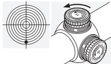
Ruotare il bottone zigrinato della regolazione dell'altezza in direzione della freccia H, in senso antiorario.
