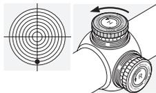
Поверните ролик коррекции по вертикали в направлении стрелки Н - против часовой стрелки.
