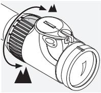
Suurennoosuhtetta voidaan säätää kiertämällä portaatonta suurennoksensäätöä 180 asteen verran.
