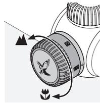
Met de parallax-toren kunt u de optimale scherpste voor elke richtafstand instellen en richtfouten door parallax vermijden.
