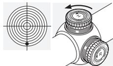
Tournez la vis moletée du réglage vertical dans le sens de la flèche H - dans le sens inverse des aiguilles d'une montre.
