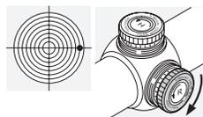
Tournez la vis moletée du réglage latéral dans le sens inverse de la flèche R - dans le sens des aiguilles d'une montre.
