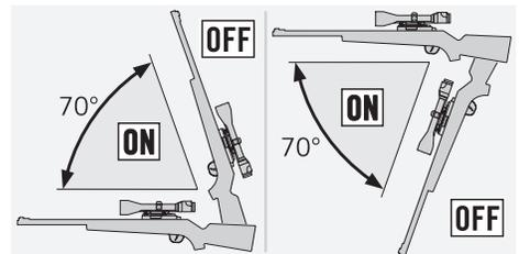
Оптический прицел также отключается при боковом уклоне более  $30^\circ$  (например, когда вы кладете ружье себе на ноги).
