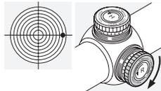
Ruotare il bottone zigrinato della regolazione laterale in senso contrario rispetto alla direzione della freccia R, in senso orario.
