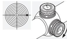
Vrid sidjusteringsratten motsatt mot pilriktningen R - dvs. medurs.
