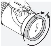
Drej først dioptri-indstillingsringen helt til venstre (mod uret) og derefter til højre, indtil sigtet viser optimal skarphed.
