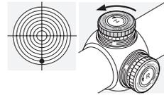
Drehen Sie den Rändelknopf der Höhenverstellung in Pfeilrichtung H - gegen den Uhrzeigersinn.
