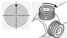
Tournez la vis moletée du réglage vertical dans le sens inverse de la flèche H - dans le sens des aiguilles d'une montre.
