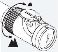
Door de vergrotingsstelring 180° te draaien kunt u de gewenste vergroting traploos instellen. De schaal op de stelring maakt een eenvoudig en praktisch aflezen van de instelling mogelijk.
