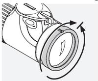
Tournez la bague de réglage de la dioptrie entièrement vers la gauche (dans le sens horaire inverse) puis vers la droite, jusqu'à ce que le réticule soit le plus net possible.
