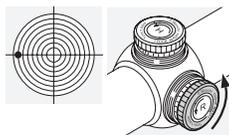
Gire la rueda estriada de reglaje del ajuste lateral en el sentido de la flecha R, en sentido contrario al de las agujas del reloj.
