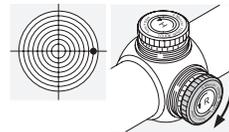
Draai de kartelknop van de zijdelingse verstelling tegen de pijlrichting R in - met de wijzers van de klok mee.
