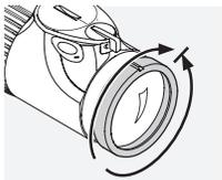
Gire primero el anillo de corrección ajuste de dioptrías completamente hacia la izquierda - en el sentido contrario de las agujas del reloj - y luego hacia la derecha hasta que la
