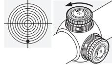
Vrid höjdjusteringsratten i pilriktningen H - dvs. moturs.
