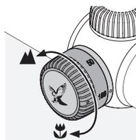
С помощью барабанчика прицельная марка оптимально фокусируется на объект на любом удалении, при этом исключается погрешность вследствие параллакса.
