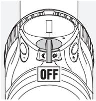
Käntämällä valaisulaitteen kytkin keskiasentoon, saadaan valaisulaitteen virta pois päältä.
