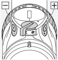
En el modo que usted haya seleccionado podrá ajustar la intensidad mediante los botones +/- . Para poder encontrar rápidamente la intensidad óptima, puede usted mantener presionada el botón (presión continua).
