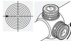
Draai de kartelknop van de zijdelingse verstelling in de pijlrichting R - tegen de wijzers van de klok in.
