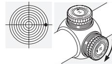
Drehen Sie den Rändelknopf der Seitenverstellung entgegen der Pfeilrichtung R - im Uhrzeigersinn.
