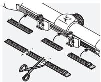
Прилагаемые защитные компоненты служат для предохранения от повреждений открытых участков шины крепления. Детали вырезают по размеру и прижимают рукой в определенных местах крепления.
