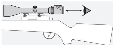
Tenez compte de la distance oculaire imposée si une lunette de visée est installée sur l'arme (voir fiche signalétique pour les mesures).
