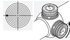
Drehen Sie den Rändelknopf der Seitenverstellung in Pfeilrichtung R - gegen den Uhrzeigersinn.
