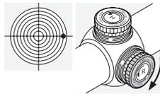
Поверните ролик коррекции по горизонтали в направлении, противоположном R - по часовой стрелке.
