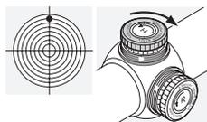
Gire la rueda estriada de reglaje del ajuste en altura en sentido contrario al de la flecha H, en el sentido de las agujas del reloj.
