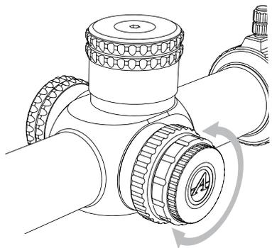
Athlon offre des réglages de luminosité variables sur les lunettes de visée Argos BTR GEN3. Les chiffres sur le bouton
