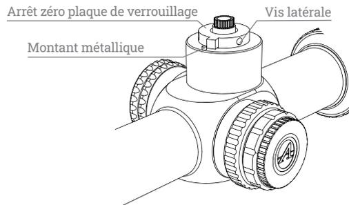
En ajustant le fusil à 100 yards, le tireur peut calculer le nombre de clics d'ajustement qui sont nécessaires pour des distances différentes, ou pour des conditions de vent. Après le tir, le tireur peut rapidement tourner le bouton d'élévation dans la direction des aiguilles d'une montre (direction vers lebas) et revenir à son/sa position zéro une fois que le bouton ne peut pas être tourné plus. N'inversez pas le bouton d'élévation une fois qu'il est arrêté.
